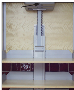
Vérifier que la sangle de levage n'est pas endommagée
