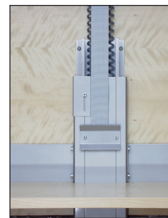
Vérifier le bon maintien de la sangle de levage sur le profil en aluminium
